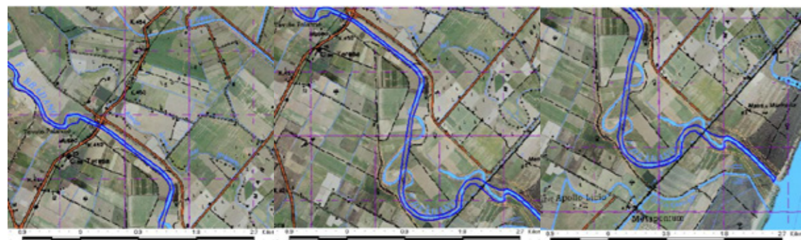
Figura 4.6. Sovrapposizione tra la carta dell'I.G.M.I. in scala 1:25000 del 1956 (in trasparenza) e le ortofotocarte in scala 1:5000 del 2004 per il tratto fluviale del Bradano in esame: a monte della S.S. 106 jonica (a sinistra), tra gli attraversamenti della S.S. 106 jonica e ferroviario (al centro) e tra la linea ferroviaria Taranto Reggio Calabria e la foce (a destra).
