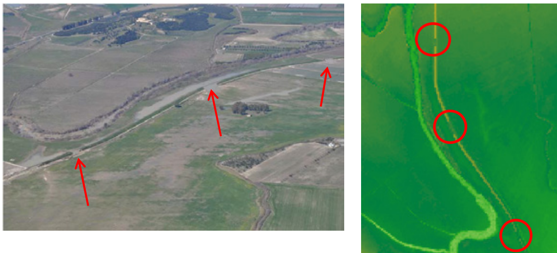
Figura 6.3. Rotture arginali lungo il fiume Bradano durante la piena del 1 marzo 2011 rilevate nei sopralluoghi (a sinistra) e rappresentate nel modello digitale del terreno (a destra).
