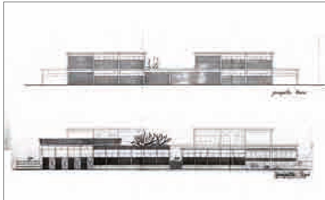
Fig 3.45 Prospetti Nord e Sud del progetto per la Scuola Elementare di Grassano dell'arch. Ludovico Quaroni, 1955. Nel prospetto Nord sono visibili i Blocchi aule a due piani collegati da una struttura orizzontale coperta. Il prospetto Sud rappresenta il fronte stradale con gli edifici utilizzati anche per attività extra-scolastiche.
