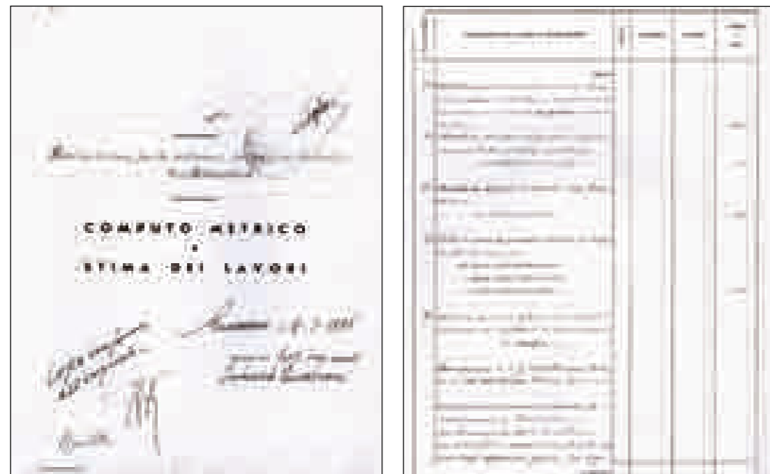
Fig 3.50 Computo metrico del progetto della Scuola Elementare di Grassano dell'arch. Ludovico Quaroni, 1955. La voce n°77, inserita nella pagina sulla destra, riporta la dicitura: "Vedetta in cemento armato per sopralluce finestra aule", essa contraddistingue gli elementi traforati inseriti nei prospetti.
