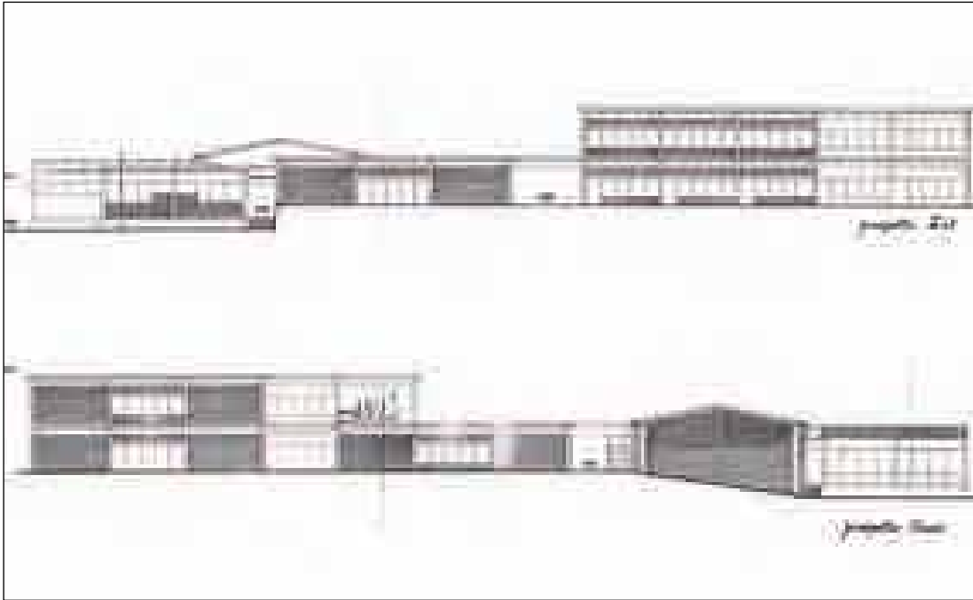
Fig 3.44 Prospetti Est ed Ovest del progetto per la Scuola Elementare di Grassano dell'arch. Ludovico Quaroni, 1955. I disegni mostrano un salto di quota che va da +2,00 m. a +1,00 m. fino ad arrivare a quota stradale di 0.00 m.
