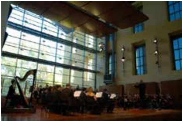
Figura 20: Particolare riflettori acustici orientabili in rovere ancorati alla copertura mediante tiranti in acciaio nell'Auditorium Paganini di Parma, Renzo Piano
