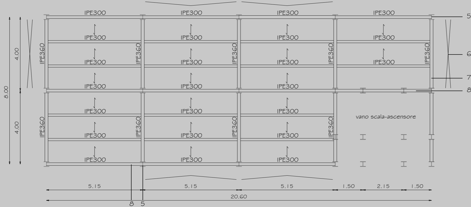
CARPENTERIA PIANO SECONDO q: +6.85m SCALA 1:100
