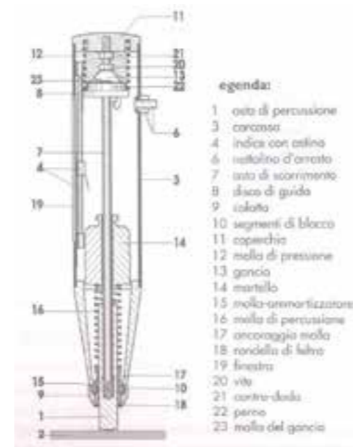
Figura 4: Sezione di uno Sclerometro
