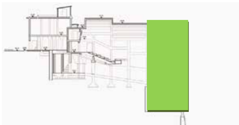
Figura 1: Sezione trasversale con individuazione del volume demolito
