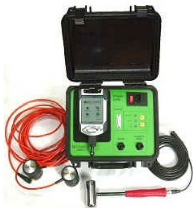
Figura 6: Apparecchio per indagine ultrasonica
