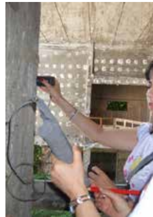
Figura 12: Esecuzione delle scansioni pacometriche
