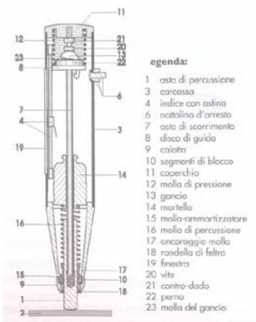
Figura 4: Sezione di uno Sclerometro
