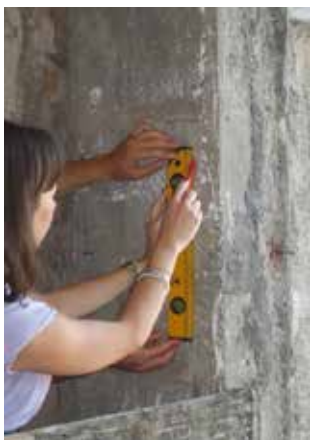
Figura 13: tracciamento del percorso delle armature sul calcestruzzo
