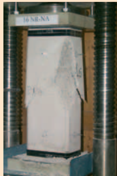
Prova di compressione a rottura su pilastro in calcestruzzo
