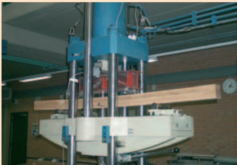
Prova di flessione su trave di legno
