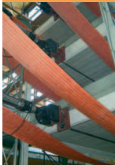
Prova pseudodinamica su modello in grande scala
