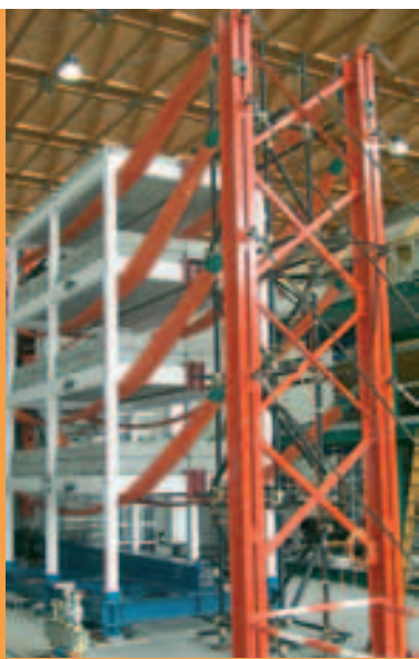
Modello in grande scala in prova pseudodinamica
