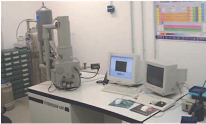
**Figura 3.7** Microscopio elettronico a scansione
