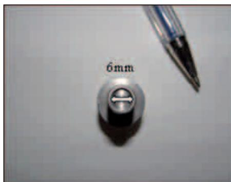
**Figura 3.5 Portacampione per analisi di polveri al microdiffrattometro**
