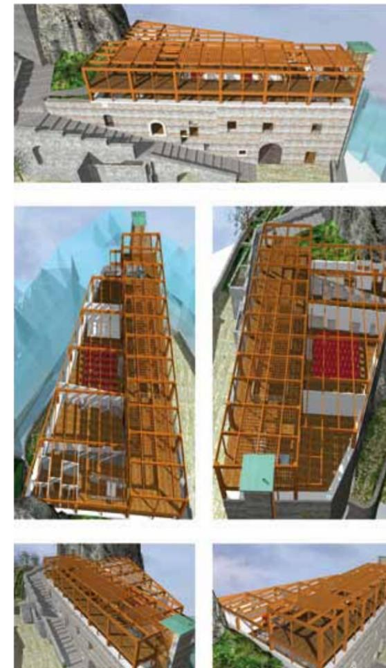
Figura 10.8 Modelli tridimensionali della struttura di copertura progettata
