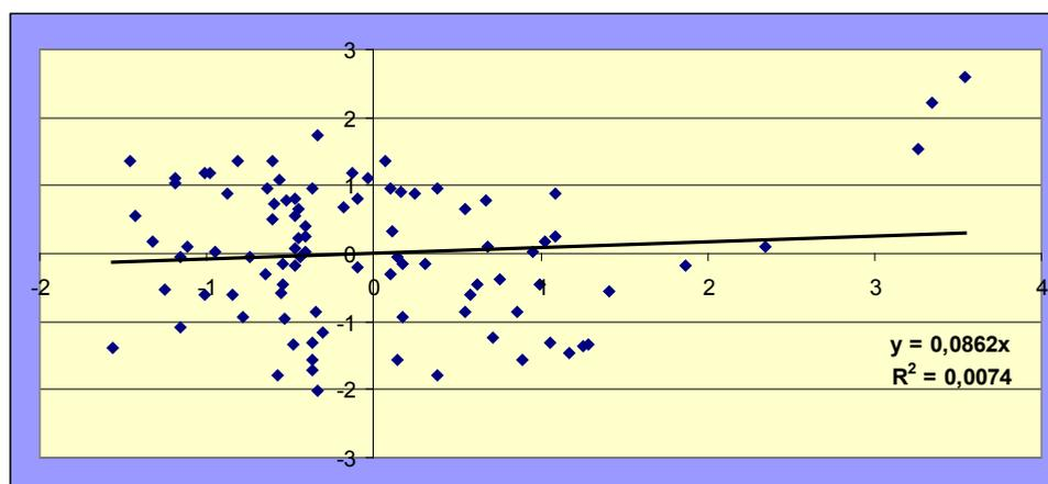
Figura 4.29: Esempio di assenza di correlazione (Cloruri- Ossigeno disciolto)
